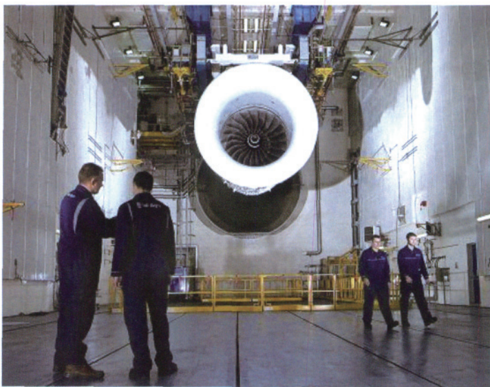
图3 在57号室内试车台上试验中的遛达XWB发动机
